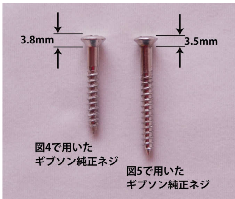
図 6 ギブソン純正ネジ「ねじ呼び径 4.1 (頭部外径 \phi 8.2)」のネジ頭部の寸法
